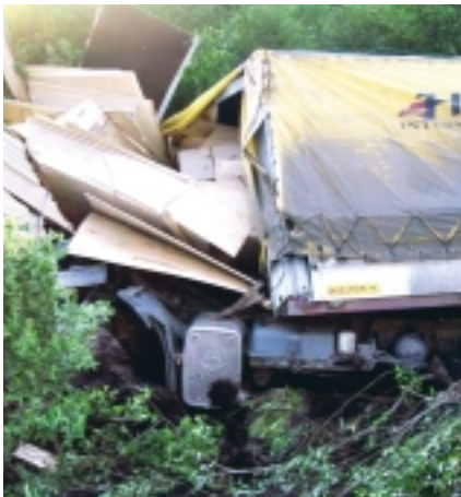
При недостаточном прижиге вибрация отрывает груз от настила, груз смещается и...
