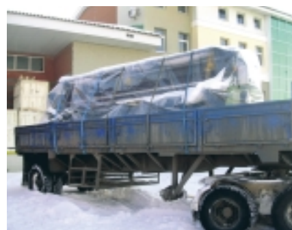
Ремни, заведенные через борта, обжимают борта, вместо того чтобы прижимать груз к настилу
