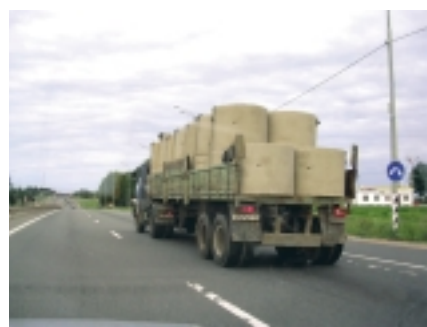
Такое крепление ЖБИ не обеспечит неподвижность груза
