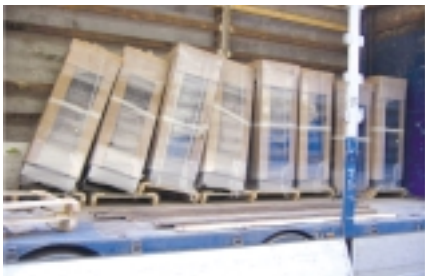
Единичная GE опрокидывается при угле наклона 33,5°
