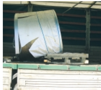
Недостаточно закрепленный передний опорный брус салазок позволяет рудонцу сместиться вперед, увеличивая плечо опрокидывающего момента
