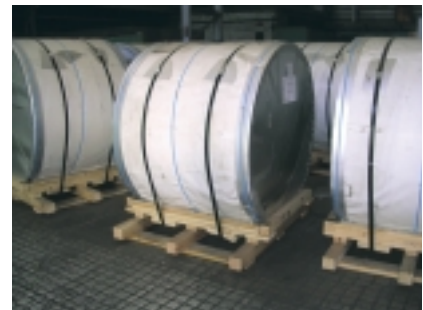
Недостаточно закрепленный передний опорный брус салазок позволяет рудонцу сместиться вперед, увеличивая плечо опрокидывающего момента
